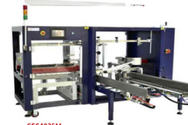
CE54035M Carton Erector & Bottom Sealer 自动开箱封底机 Suitable Cases/适用纸箱: L200-500mm W150-350mm H100-350mm Height of table/台面高度: H650mm Work speed/封箱速度: 1-10carton/min. Air Source/气源: > 500L/min, 0.4-0.8 Mpa Opp tape/使用胶带: W48mm-W60-75mmxL1000
