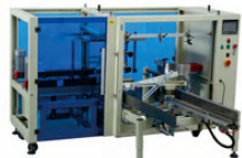
CE54035N/A Carton Erector & Bottom Sealer 自动开箱封底机 Suitable Cases/适用纸箱: L200-500mm W150-350mm H100-350mm Height of table/台面高度: H650mm Work speed/封箱速度: 1-10carton/min. Air Source/气源: > 500L/min, 0.4-0.8 Mpa Opp tape/使用胶带: W48mm-W60-75mmxL1000
