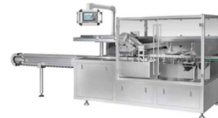
装盒式包装机 技术参数 Main Technical Parameter 装盒速度/箱速/Encasing Speed(cartons/min) 20 \sim 120 (视盘盒要求而定/平方米) Carton Quality Requirement(g/m 2 ) 250 \sim 350 (视盘盒大小而定/定盘盒carton size) 盘盒尺寸范围(长*宽*高)mm Carton Dimension Range(L*W*H)mm ( 65 \sim 155 ) ( 30 \sim 85 ) ( 14 \sim 50 )
