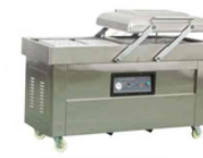
DZ(Q)500/25B & DZ(Q)600/25B Vacuum (pneumatic) Packager 真空 (充气) 包装机 Chamber size/真空腔尺寸: 540x570x50mm DZ(Q)500/25B 540x670x50mm DZ(Q)600/25B Double sealing-bar/双封条尺寸: 620x10mm DZ(Q)500/25B 620x10mm DZ(Q)600/25B Capacity/排气量: 2x20m3/h DZ(Q)500/25B 40m3/h DZ(Q)600/25B Cycle time/循环时间: 10-35sec DZ(Q)500/25B 10-40sec DZ(Q)600/25B Power/功率: 1.5KW DZ(Q)500/25B 3.2KW DZ(Q)600/25B
