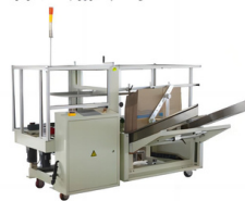
CE54035N Carton Erector & Bottom Sealer 自动开箱封底机 Suitable Cases/适用纸箱: L200-500mm W150-350mm H100-350mm Height of table/台面高度: H650mm Work speed/封箱速度: 1-10carton/min. Air Source/气源: > 500L/min, 0.4-0.8 Mpa Opp tape/使用胶带: W48mm-W60-75mmxL1000
