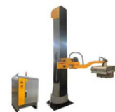
WKD-XMD10 机器人 适用托盘尺寸: 1800 \times 1200 \times 150 \sim 200\text{mm} 适用托盘方式: 人工放置 适用托盘重量: 5 \sim 0.8\text{kg/m}^2 适用电压: 三相 380\text{V} 50\text{Hz} 适用气压: 5 \sim 0.8\text{kg/cm}^2 设备功率: 9\text{kW} 适用高度: 最大高度 1500 \sim 1800\text{mm}
